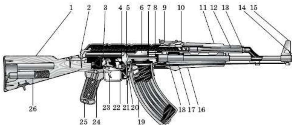
**Рис. 10.** Устройство автомата: 1 – приклад; 2 – выступ направляющего стержня возвратного механизма; 3 – переводчик; 4 – крышка ствольной коробки; 5 – курок; 6 – затворная рама; 7 – ударник; 8 – затвор; 9 – прицельная планка; 10 – колодка прицела; 11 – ствольная накладка; 12 – газовый поршень; 13 – газовая трубка; 14 – муфта ствола; 15 – основание мушки; 16 – цевье; 17 – шомпол; 18 – ствол; 19 – магазин; 20 – защелка
