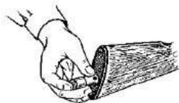
**Рис. 18.** Вкладывание пенала в гнездо приклада магазина
