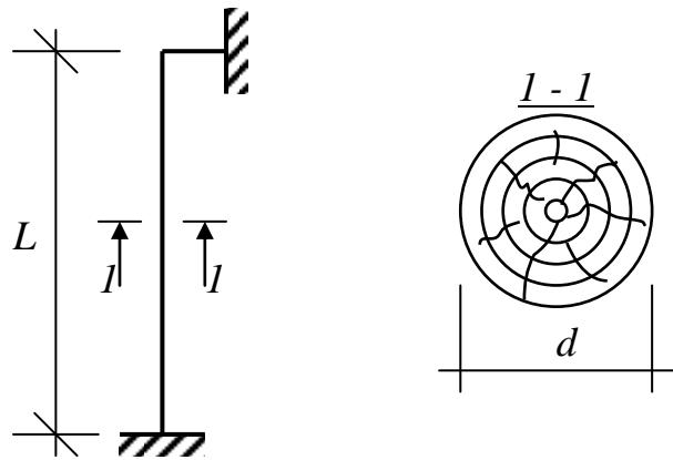
12. Построить эпюры  $M$  и  $Q$  (рис.12.). Дано:  $P=6\text{kH}$ ;  $L=4\text{м}$ .
