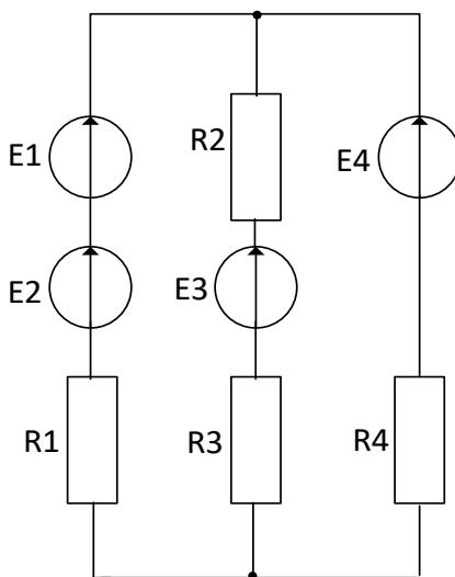
Дано:  $R_1=10 \text{ Ом}$ ,  $R_2=20 \text{ Ом}$ ,  $R_3=15 \text{ Ом}$ ,  $R_4=30 \text{ Ом}$ ,  $E_1=5\text{В}$ ,  $E_2=12\text{В}$ ,  $E_3=24\text{В}$ ,  $E_4=36\text{В}$ . Найти:  $I_1, I_2, I_3$
