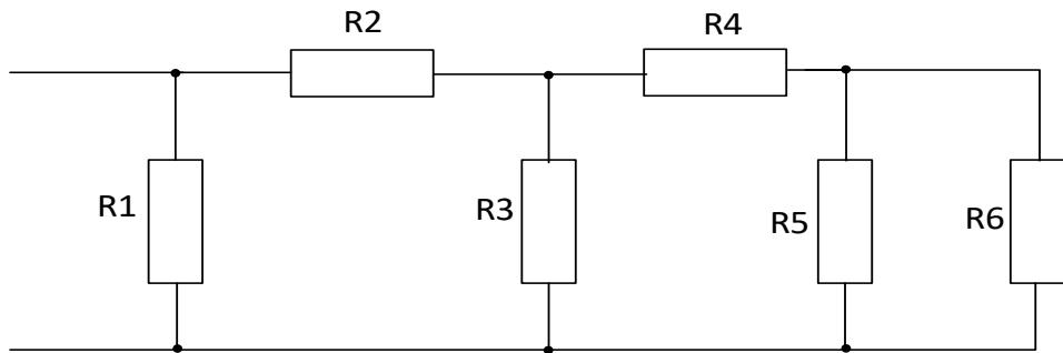
Дано:  $R_1=40 \text{ Ом}$ ,  $R_2=30 \text{ Ом}$ ,  $R_3=20 \text{ Ом}$ ,  $R_4=10 \text{ Ом}$ ,  $R_5=20 \text{ Ом}$ ,  $R_6=20 \text{ Ом}$ ,  $U_5=30 \text{ В}$ . Найти:  $R_{общ}$ ,  $U_{общ}$ ,  $I_{общ}$ , напряжение на каждом резисторе и ток через каждый резистор.
