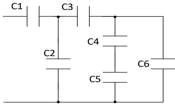
Дано:  $C_1 = C_2 = C_3 = C_4 = C_5 = C_6 = 1,5 \text{ мкФ}$ .  $U_6 = 3\text{В}$ . Найти: Собщ,  $U_{общ}$ ,  $q_{общ}$
