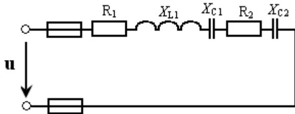
Активное сопротивление катушек  $R_{k1}=5\text{Ом}$ ,  $R_{k2}=12\text{Ом}$  индуктивное  $X_L=10 \text{ Ом}$ . Последовательно с катушкой включено активное сопротивление  $R_1 = 5 \text{ Ом}$  и  $R_2=12 \text{ Ом}$ , конденсаторы сопротивлением  $X_{c1} = 10 \text{ Ом}$ ,  $X_{c2} = 8 \text{ Ом}$ . К цепи приложено напряжение  $U=50\text{В}$  (действующее значение).
