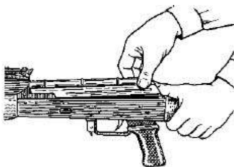
Рис. 13. Отделение крышки ствольной коробки
